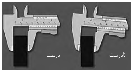
اندازه گیری قطر یا ضخامت خارجی
